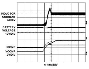
FIGURE 10. BATTERY INSERTION
