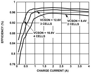
FIGURE 15. EFFICIENCY vs CHARGE CURRENT
