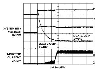
FIGURE 8. AC ADAPTER INSERTION
