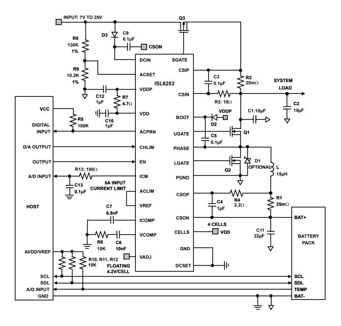
FIGURE 17. TYPICAL APPLICATION CIRCUIT 1
